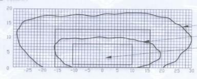
实际20cd等光强图 Actual Isocandela Curve of 20cd 实际100cd等光强图 Actual Isocandela Curve of 100cd
